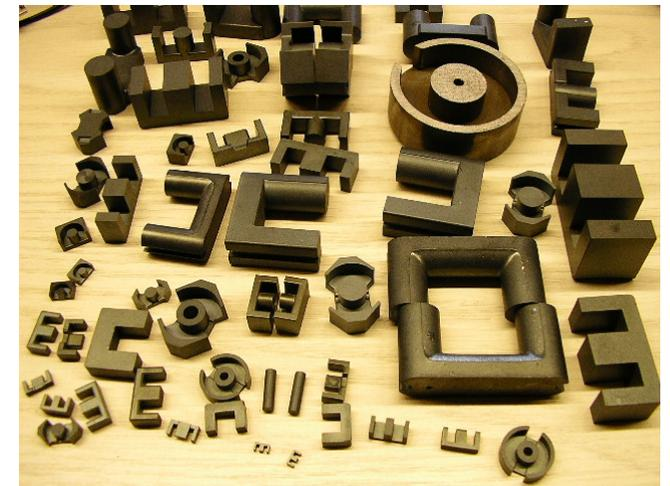
Die Verluste werden hauptsächlich durch Wirbelströme (Leitfähigkeit des Kernmaterials) und Elektronenplatzwechsel im Kristall verursacht. Auch beim Kernmaterial tritt der Skineneffekt auf (Verdrängung an die Oberfläche)
